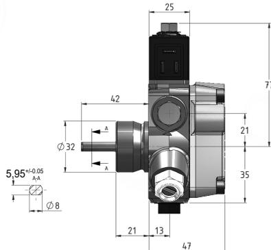
Arrivée ① et retour ② avec étanchéité directe (l'étanchéité avec rondelle sur lamage reste possible)
