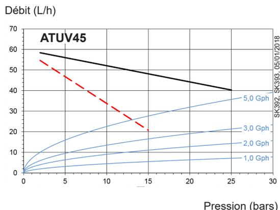
Les caractéristiques indiquées tiennent compte d'une marge d'usure. Ne pas sur-dimensionner les pompes lors du choix de la capacité d'engrenage.
