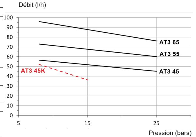
Les caractéristiques indiquées tiennent compte d'une marge d'usure. Ne pas sur-dimensionner les pompes lors du choix de la capacité d'engrenage afin d'assurer un fonctionnement optimum de l'électrovanne (NO) de changement d'allure.
