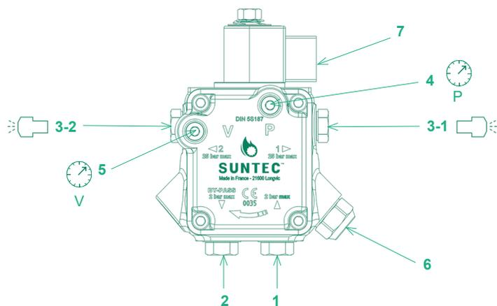
Le dessin indique une pompe AUV 47L 9877 6P 0700, pour la pompe AUV 47R 9876 6P 0700 seul le sens de rotation est inversé.
