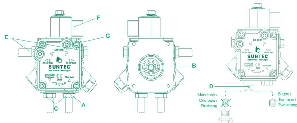
**A**• Vérifier le sens de rotation (flèche sur le couvercle).
